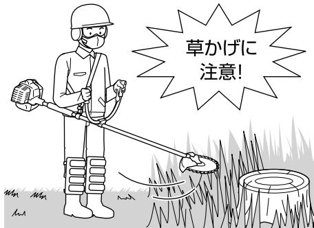
万一千キックバックが発生しても、危険性を最小限にするため、刈払機を体の右側にして作業してください。
