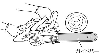
**注** チェンオイルの補給は、燃料を補給するたびに行ってください。
