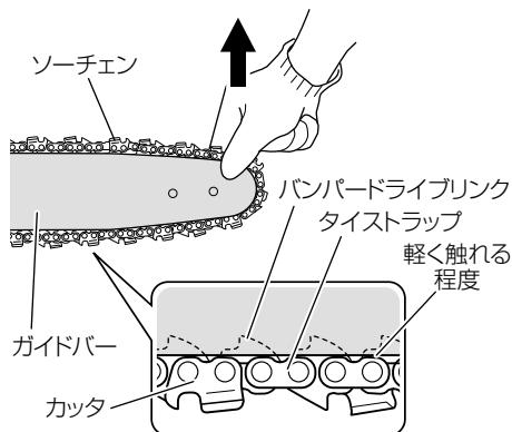
**3** 調整が終わりましたら、ガイドバー先端を持ち上げながらガイドバー取付ナットを付属のボックススパナでしっかりと締めてください。
