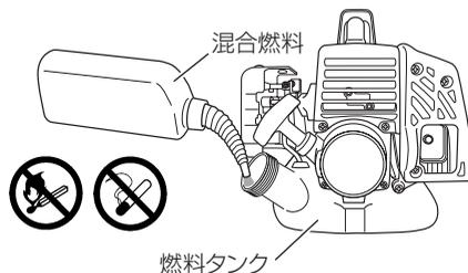
**注** 燃料タンクキャップは、確実に取付けてください。
