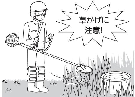
万一キックバックが発生しても、危険性を最小限にするため、刈払機を体の右側にして作業してください。
