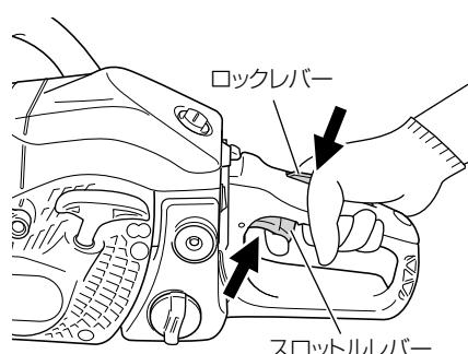
**10** 使用前にスロットルレバーを放して低速運転（アイドリング運転）で2～3分間暖機運転をしてください。
