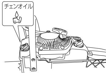
**注** • チェンオイルの補給は、燃料を補給するたびに行ってください。
