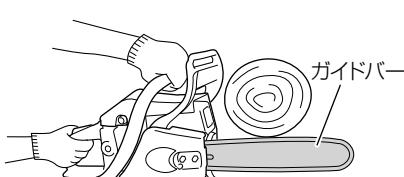
**注** チェンオイルの補給は、燃料を補給するたびに行ってください。
