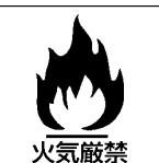
引火しやすい燃料を使用するため、本機に火気を絶対に近付けないでください。
