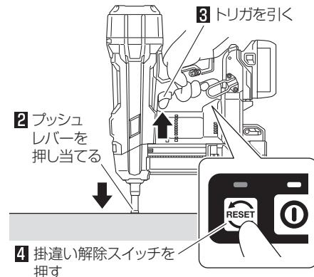
**注** モーターが駆動して部品の噛み合いが正常になると、掛違い検出ランプが消灯します。掛違い検出ランプが点灯し続ける場合は、上記の②～④を何度も繰り返してください。
