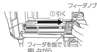
**4** フィーダを押していた指をはなし、フィーダの先端部が釘の連結後端を押すように静かに戻します。
