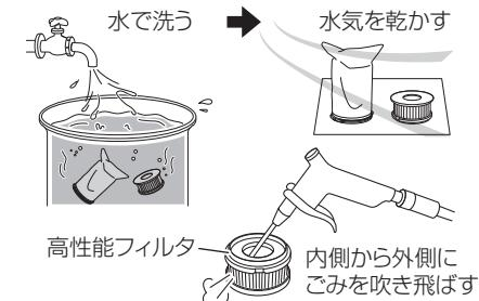
空気圧力：一般圧 (0.6 MPa 程度)
