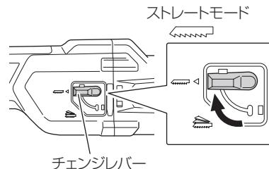
注 ストロークモードの選択は、製品が完全に停止した状態で、チェンジレバーを操作してください。
