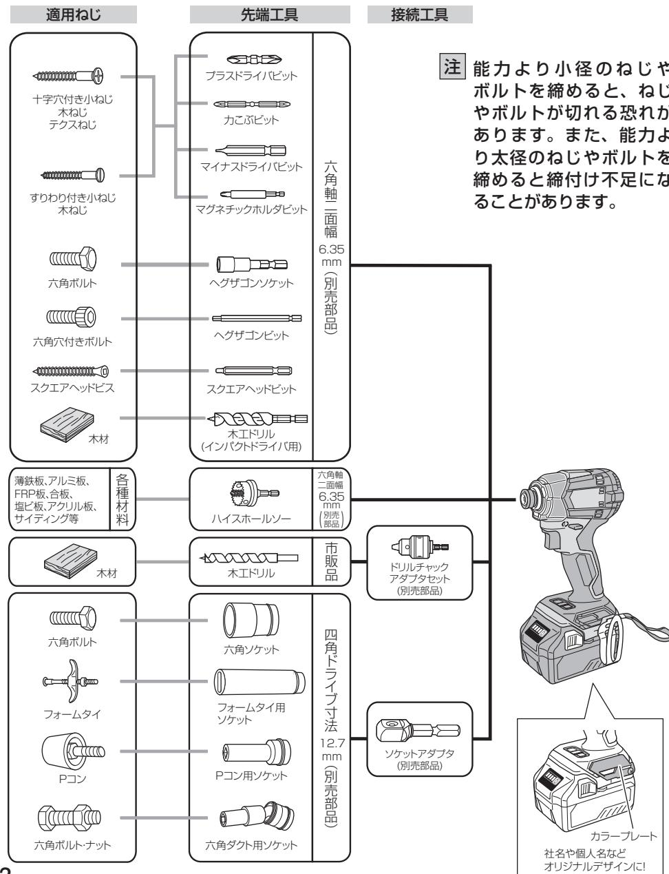
**注** 能力より小径のねじやボルトを締めると、ねじやボルトが切れる恐れがあります。また、能力より太径のねじやボルトを締めると締付け不足になることがあります。
