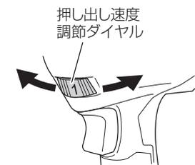
**注** ノズルの切断面が小さい場合や、シーリング材が低温のときに勢い良く押し出すと、ピストン側に漏れたり、カートリッジが破損する恐れがあります。
