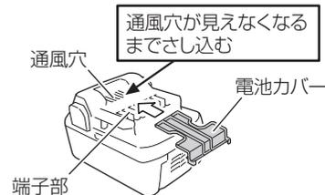
**注** リチウムイオン電池を保管するときは、満充電にして保管してください。蓄電池の残量が少ない状態で長期間（3か月以上）保管すると蓄電池が劣化し、使用時間が著しく短くなる、または充電できなくなる恐れがあります。充電と使用を繰り返しても使用時間が極端に短い場合は、蓄電池の寿命とご判断いただき、新しい蓄電池をお買い求めください。
