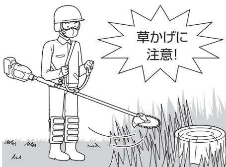
万一キックバックが発生しても、危険性を最小限にするため、刈払機を体の右側にして作業してください。
