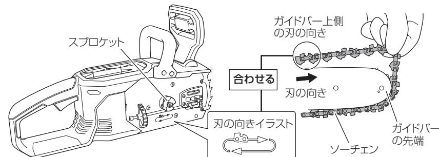
ソーチェンがガイドバーからはずないように先端を押さえながら、右のイラストのようにソーチェンの端をスプロケットにかみ合わせ、ガイドバーを取付けます。
