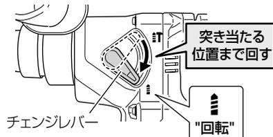
**注** チャックアダプタを使用して"回転+打撃"の作業はしないでください。
