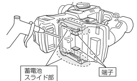
コンクリート穴あけ後、右図各部にコンクリート粉じんが付着した際は、乾いた布やエアガンなどで付着したコンクリート粉じんを掃除してから、使用してください。
