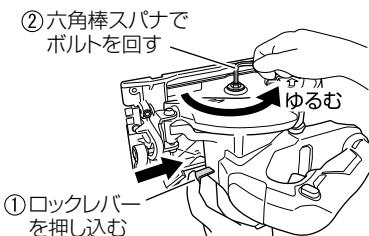
**3** 六角棒スパナを反時計方向に回し、ボルトとワッシャ(B)をはずす
