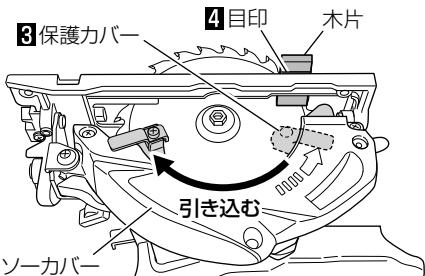
**4** 目印を付けた木片をベース前方側に移動し、平行度調整ねじをお手持ちのプラスドライバーで回して目印がベース側面に合うようにします。
