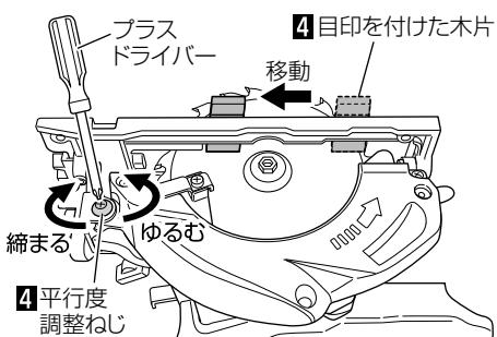
**5** 調整後、固定ねじをしっかりと締付けます。
