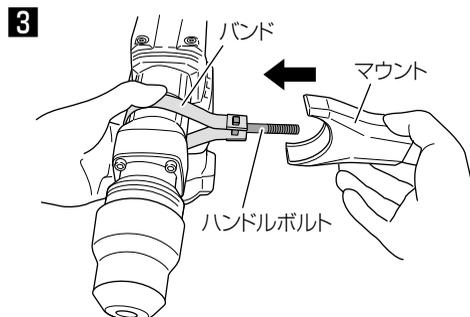
**4** 作業に適した位置に合わせ、サイドハンドルを回して固定します。この際、確実に固定されていることを確認してください。
