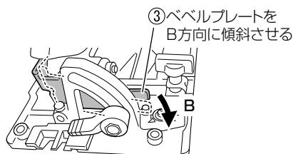
③ ベベルプレートをB方向に傾斜させる
