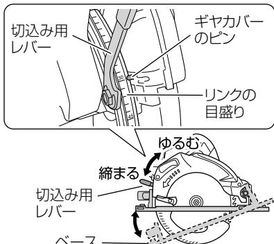
**注** 目盛り線は目安のため、正確に調整するときはのこ刃を測定してください。
