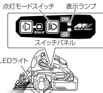
**注** •連続点灯モードは、LED ライトの消し忘れによる電池の消耗を防止するため、約 2 分経過すると自動で消灯します。
