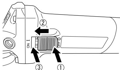
スイッチは①の方向に押して、②の方向にスライドさせたあと、③の方向に押し込むとスイッチがロックされ、連続運転ができます。
