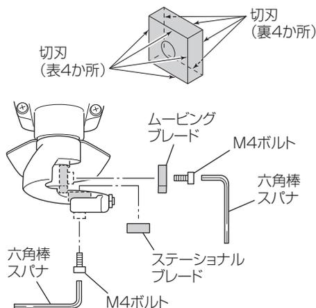
**注** 切れ味が落ちたら切刃を変えるか、新しいブレードと交換してください。切断面がきれいに切れないばかりでなく、機体に負荷がかかり、作業効率も上がりません。
