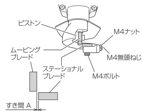
**注** ●ブレードの間のすき間が切断する板材の厚さに対して大きすぎると、まくれができて切断面がきれいになりません。
