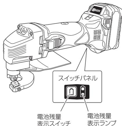
**注** 残量表示機能のある蓄電池を使用する際は、蓄電池側の残量表示を参照してください。
