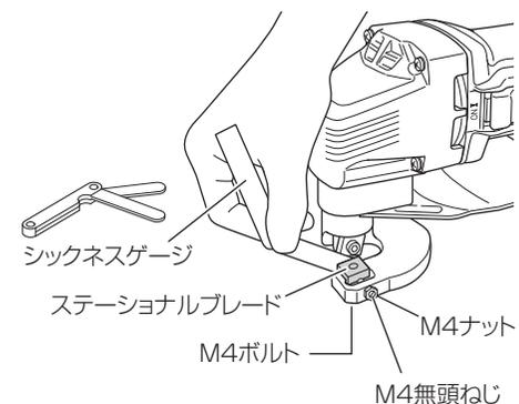
**注** ムービングブレードとピストン、およびステーションナルブレードと、M4 無頭ねじとの間にガタのないようにしっかりと押し付けてから、M4 ボルトをしっかりと締付けてください。ブレードを締付けている M4 ボルトがゆるむと、切れ味が悪くなったり、切刃が損傷する原因になります。
