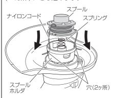
スプールのコードホルダからナイロン コードをはずして、スプールをスプー ルホルダに収納し、キャップを取付け ます。
