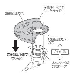
**2** 付属の取付ねじ(4本)で飛散防 護力バーを固定します。
