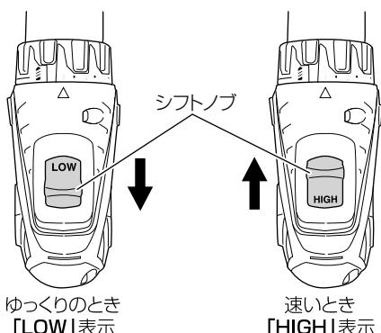
**注** • シフトノブで回転数を切り替えるときは、必ずスイッチを切り、モーターが停止していることを確かめてください。
