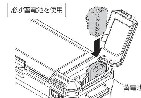
注 DC 12 V 出力に使用している蓄電池は、家庭用 100 V 電源、および車載電源からの充電は行われません。蓄電池 2 個装着の場合、DC 12 V 出力に使用していない蓄電池は、家庭用 100 V 電源、および車載電源から充電を行います。
