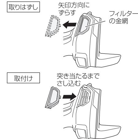
**注** • フィルターが破損しているときは、新品と交換してください。
