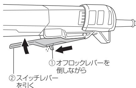
オフロックレバーは、スイッチレバーを引くことで倒れた状態に固定され、スイッチレバーをはなすと自動的に戻ります。
