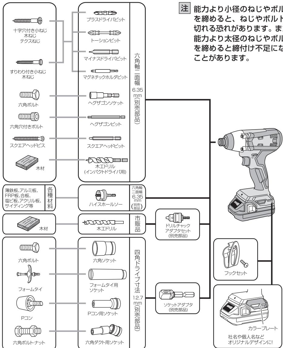
**注** 能力より小径のねじやボルトを締めると、ねじやボルトが切れる恐れがあります。また、能力より太径のねじやボルトを締めると締付け不足になることがあります。
