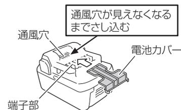
**注** リチウムイオン電池を保管するときは、半分程度の容量で保管してください。蓄電池の残量が少ない状態で長期間（3か月以上）保管すると蓄電池が劣化し、使用時間が著しく短くなる、または充電できなくなる恐れがあります。充電と使用を繰り返しても使用時間が極端に短い場合は、蓄電池の寿命とご判断いただき、新しい蓄電池をお買い求めください。
