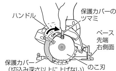
注 サブベースをはずした逆傾斜の状態では、のこ刃がベースの右側面より出ている場合は、傾斜角度を少し戻すとこの刃のばり量を減らすことができます。
