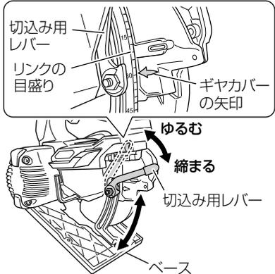
**注** 目盛り線は目安のため正確に調整するときには、のこ刃のどばり量を実測してください。
