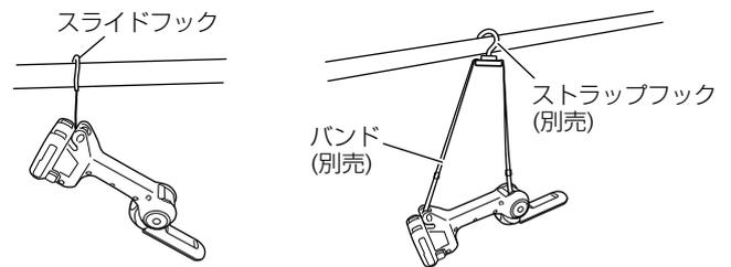
**注** フック使用時は、機体が落下しないように必ずひもなどでフックがパイプからはずれないように固定して、落下防止してください。
