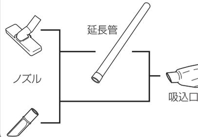
**注** ノズルや延長管は、矢印の方向にねじりながらしっかりとさし込んでください。取りはずす場合も矢印方向に回してください。反対方向に回しますと、ダストケースがハウジングからはずれることがあります。
