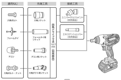
注 能力より小径のボルトを締めると、ボルトが切れる恐れがあります。また、能力より太径のボルトを締めると締付け不足になることがあります。
