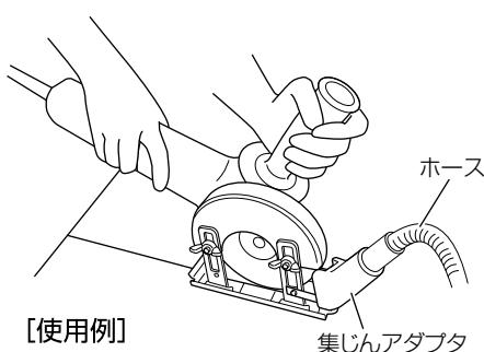
**5** 集じんアダプタのホース取付け口に、電動工具用集じん機(別売部品)のホースを取付けて使用してください。
