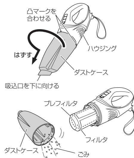
**注** プレフィルタおよびフィルタは、正しく取付けてないと故障の原因になります。
