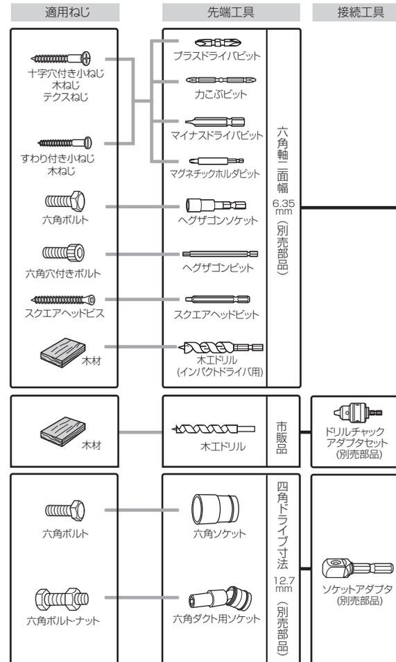
**注** 能力より小径のねじやボルトを締めると、ねじやボルトが切れる恐れがあります。また、能力より太径のねじやボルトを締めると締付け不足になることがあります。
