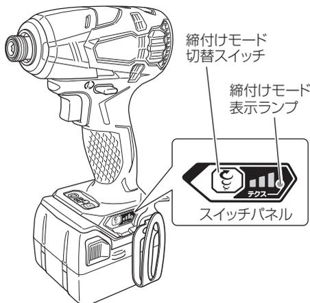
締付けモード切替機能の設定例
