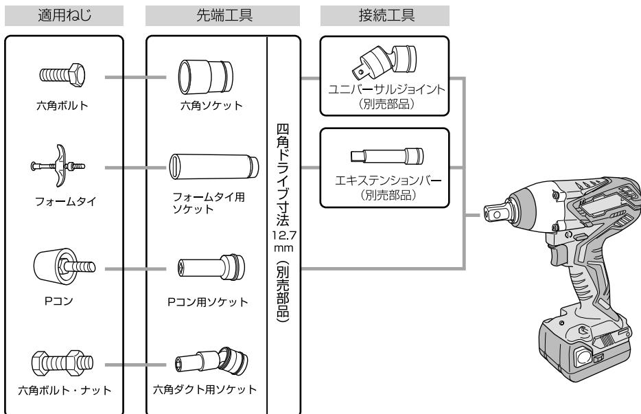
**注** 能力より小径のボルトを締めると、ボルトが切れる恐れがあります。また、能力より太径のボルトを締めるとき締付け不足になることがあります。
