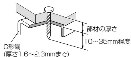
**注** • 鋼板打ちでの打ち込み過ぎは、極端に保持力が低下しますので、打ち込み深さを使用空気圧力、アジャスタ (P.22「打ち込み深さの調整」参照) で調整して、使用してください。
