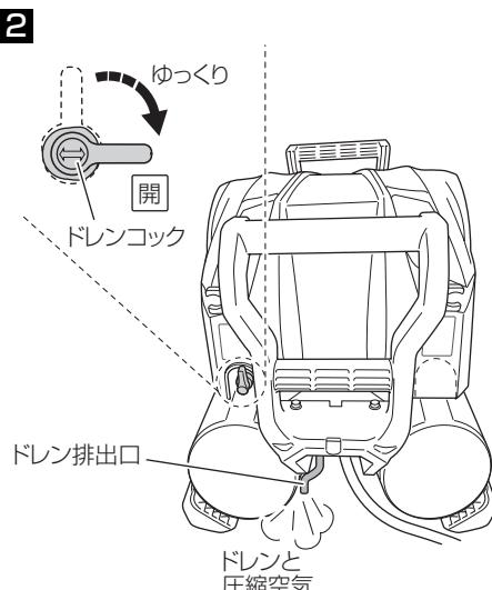
**3** 空気タンク内のドレンがすべて抜けていることを確認してから、ドレンコックを閉じて、エアホースをはずしてください。
