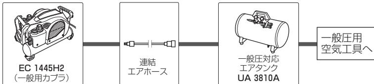
●本機の高圧専用エアタンク接続口に、【UA 545 H2】に同梱の接続用カプラ、別売の補助タンク用ホースを使用して、高圧エアタンク【UA 545 H2】を接続できます。
