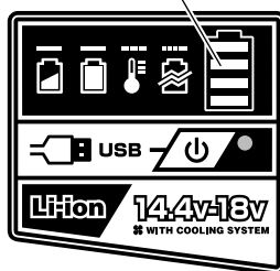
電池容量ランプ
