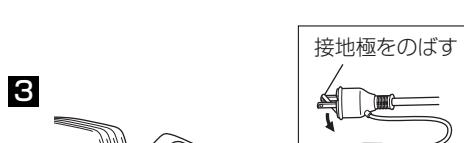
3 電動工具が 3P (可倒式) 電源プラグの場合は、接地極端子を伸ばしてから連動用コンセントにさし込み、右に回してください。
