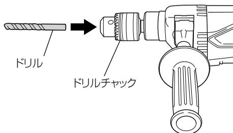
**2** ドリルチャック外周の3カ所の穴にチャックハンドルを順々に入れて矢印の「締まる」方向に回し、ドリルを軽く締付けていきます。最後に3カ所とも均等の力でしっかりと締付け、ドリルを確実に固定してください。
