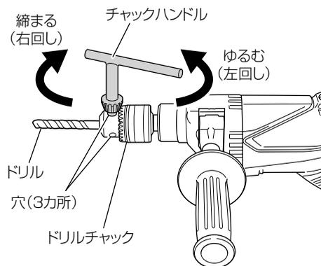
**3** ドリルを取りはずすときは、矢印の「ゆるむ」方向にチャックハンドルを回します。
