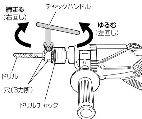
**3** ドリルを取りはずすときは、矢印の「ゆるむ」方向にチャックハンドルを回します。
