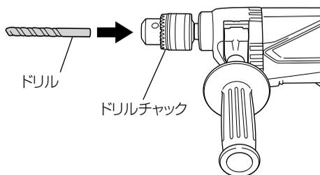
**2** ドリルチャック外周の3カ所の穴にチャックハンドルを順々に入れて矢印の「締まる」方向に回し、ドリルを軽く締付けていきます。最後に3カ所とも均等の力でしっかりと締付け、ドリルを確実に固定してください。
