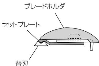
**注** 切粉排出側のセットプレート端部から替刃の端面が少し出ていることを確認してください。
