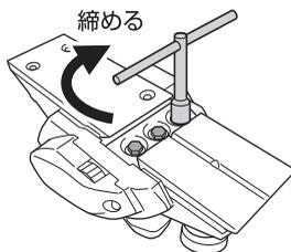
**注** セットプレートの凸部と替刃の凹部がかみ合っていることを確認してください。
