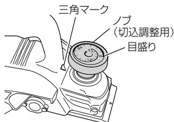
**注** 相じゃくり作業は、進行方向に対して機体の右側で行ってください。左側では、機体のベルトカバーに材料があたり、深さができません。
