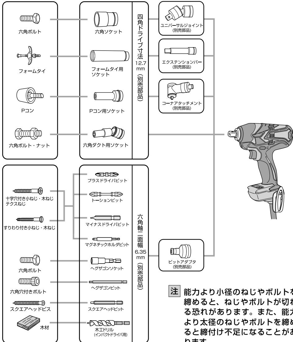
**注** 能力より小径のねじやボルトを締めると、ねじやボルトが切れる恐れがあります。また、能力より太径のねじやボルトを締めると締付け不足になることがあります。
