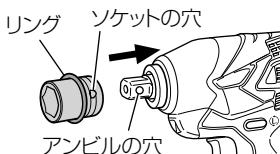
① リングを溝からずらし、アンビルの穴とソケットの穴が合うようにしてソケットをさし込みます。
