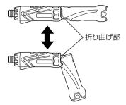
狭い場所での作業にはストレート型、その他の場所ではピストル型などと、作業用途に 応じて使い分けができます。
