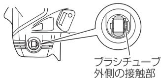
**注** カーボンブラシのツメは、必ずブラシチューブ外側の接触部に挿入してください(ツメは2カ所あるうちのどちらでも良い)。間違えるとカーボンブラシのツメが変形し、モーターの早期故障の原因になります。
