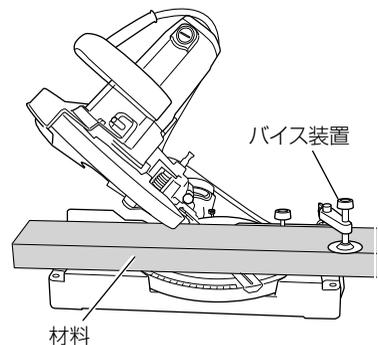
**3** 材料をフェンス面へ確実に押し当て、ノブを回して固定します。
