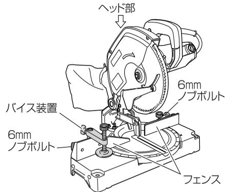
**2** 6mm ちょうボルトをゆるめることにより、材料の高さにあわせてスクリュホルダを上下に調節できます。調節後、6mm ちょうボルトを締め、スクリュホルダを固定します。
