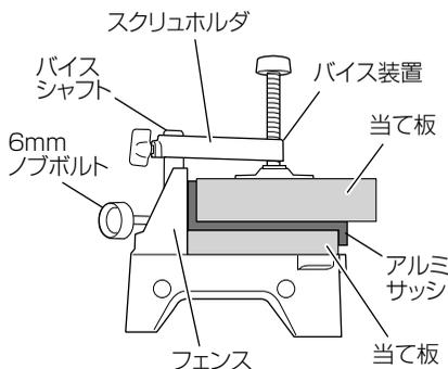
さらにU形状の材料の場合は、横方向の固定を確実にします。右図で示すように当て板を使用し、材料の切断部の近くまで挟んでバイス装置と市販のクランプを併用して締付けてください。
