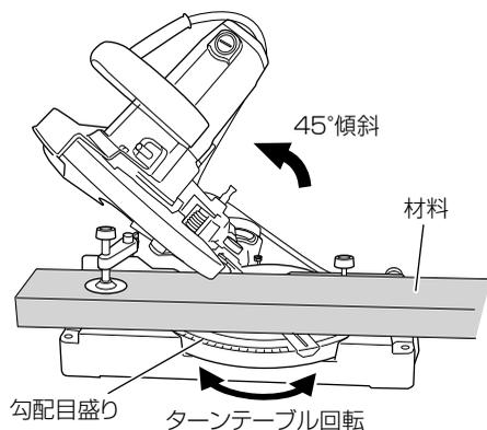
**2** 高さ 59 mm から 64 mm までの配付けだる木加工の場合、のこ刃傾斜角度およびターンテーブル回転角度(右側)を変化させることにより高さ 59 mm から 64 mm までの配付けだる木を加工することができます。
