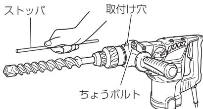
**注** ちょうボルトを紛失しないように、ストップを使用しない場合でも、ちょうボルトをしっかり締めてください。
