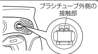
**注** カーボンブラシのツメは、必ずブラシチューブ外側の接触部に挿入してください(ツメは2力所あるうちのどちらでも良い)。間違えるとカーボンブラシのツメが変形し、モーターの早期故障の原因になります。
