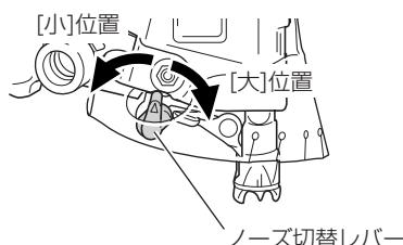
**注** • レバーを操作してノーズを切替えるときは、必ず釘ガイドを開いて使用する釘の頭径・軸径を確認して行ってください。
